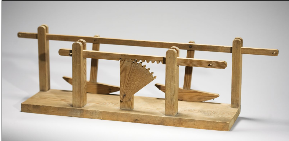
Illustration 1.15a Äldre modeller utgjorde ofta förminskade versioner av reella objekt (ett skepp, en byggnad) – men det finns undantag. Modeller i Christopher Polhems mekaniska alfabet från tidigt 1700-tal illustrerade abstrakta mekaniska principer. Till exempel modellen ovan vilken åskådliggjorde hur långa upp- och nedfodringsstänger med rundade trästötter kunde följa en rät linje under hela sin rörelse. Fotografi från Tekniska museet.
