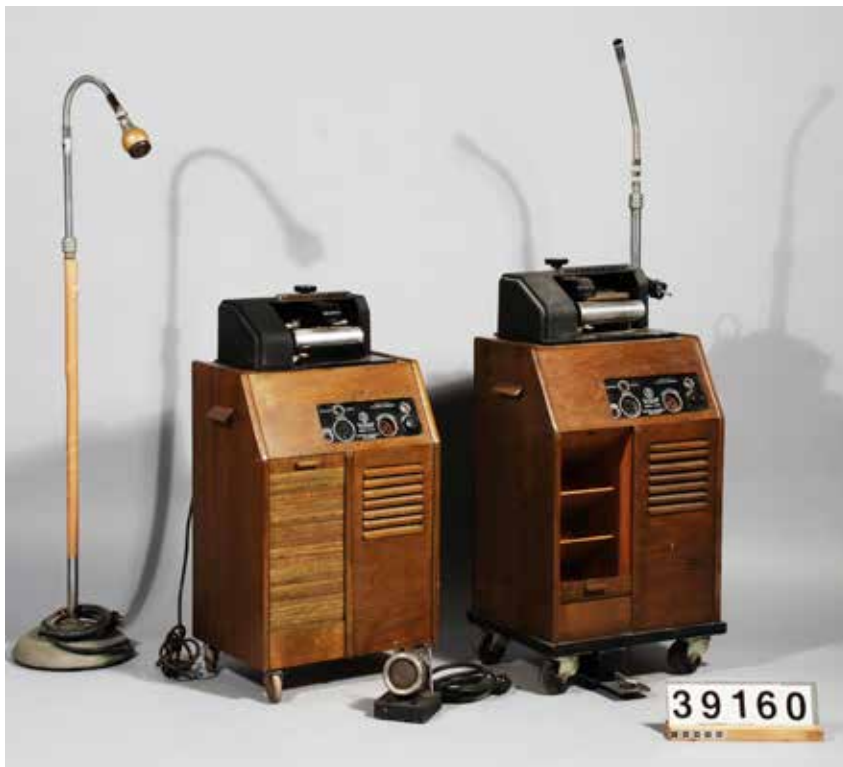
Firma AB Svenska Recording saluförde dessa dikteringsapparater i början av 1940-talet. Till diktafonerna kunde kopplas både högtalare, mikrofoner och "hörtelefon med omkopplare". Dessutom ingick ett träskåp med väl tilltagna fack för vaxrullar. Tekniska museet.
